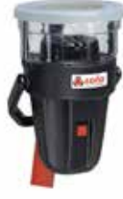
SOLO461: Kablosuz Sıcaklık Test Kiti 1xSOLO460 2xSOLO760 1xSOLO726
